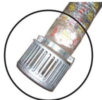
7. Ujung pipa hisap yang tidak terpasang (strainer) dimasukkan ke dalam kolam air/sumur.
